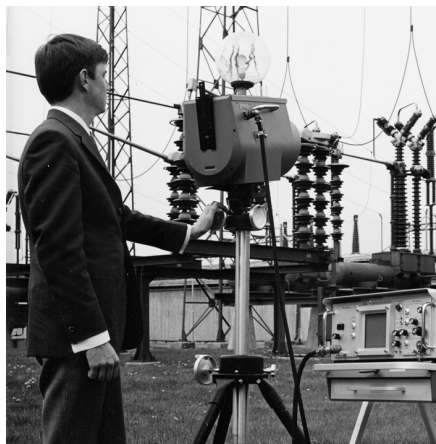
1969: Model Thermovision 661. Kamera ważyła około 25 kg, oscyloskop — 20 kg, a statyw — 15 kg. Operatorowi potrzebny był również agregat prądowórczy 220 V AC oraz 10-litrowy zbiornik z ciekłym azotem. Na lewo od oscyloskopu widoczny jest moduł Polaroid (6 kg).
