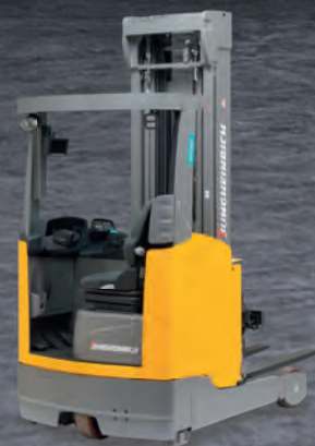
Akumulatorowy wózek widłowy wysokiego składowania z masztem wysuwным ETM/ETV 318-325 maks. wys. podn.: 13000 mm maks. udźwig: 2500 kg
