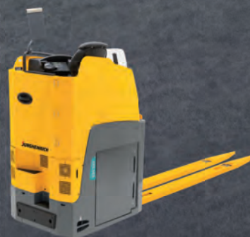
Akumulatorowy unoszący wózek widłowy z fotelem dla operatora ESE 533 trasy: długie maks. udźwig: 3300 kg
