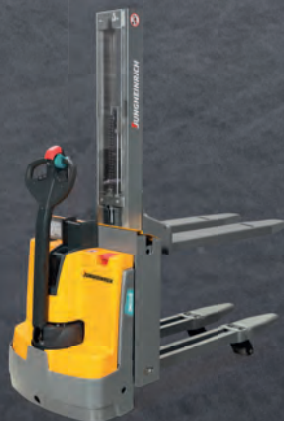
Akumulatorowy podnośnikowy wózek widłowy podwójnego załadunku z dyszlem EMD 115i/118 maks. wys. podn.: 1520 mm maks. udźwig: 1800 kg
