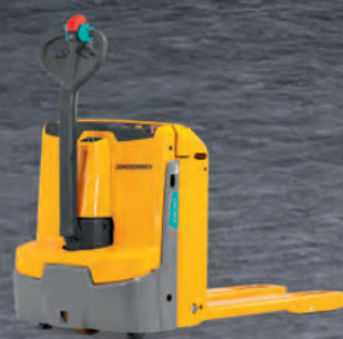
Akumulatorowy unoszący wózek widłowy z dyszlem EJE 114-120 trasy: krótkie maks. udźwig: 2000 kg
