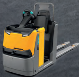
Akumulatorowy wózek widłowy do kompletacji poziomej ECE 220/225 maks. wys. kompletacji: 1 poziomy maks. udźwig: 2500 kg
